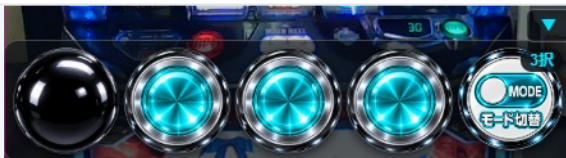
操作ボタン（左から MAX+スタートレバー・ストップ左・ストップ中・ストップ右・モード切替）
